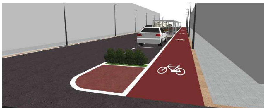
Figura 6 Para garantir o conforto e a segurança dos pedestres optou-se pela utilização de pisos planos, evitando a trepidação. O passeio apresenta faixa de serviço, onde serão inseridos os postes de iluminação pública e faixas balizadoras. Desenho dos autores.
